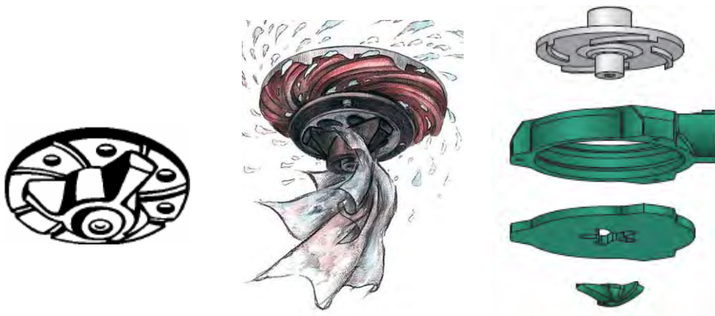
Abbildung 4-28: Laufrad mit Schneideinrichtung (JABERG, 2003; MALL, 2011; WILO, 2008)
