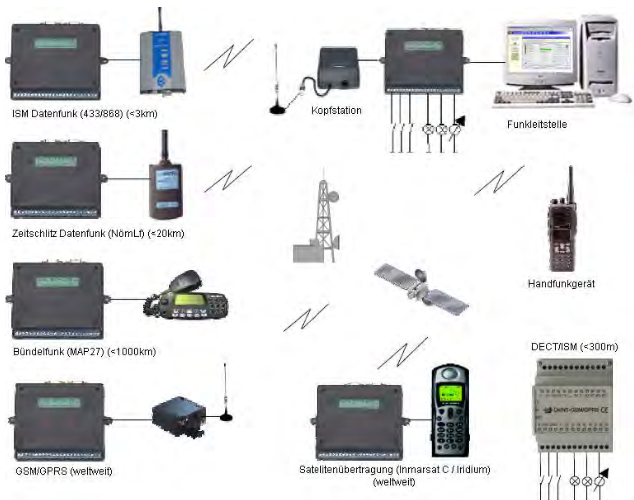
Abbildung 4-37: Möglichkeiten der Datenübertragung mittels Funk adaptiert nach DÖBELT (2010)
