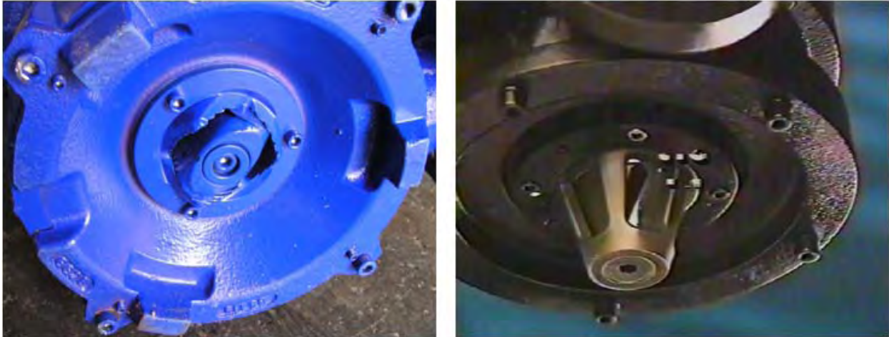
Abbildung 9-11 – Schneideinrichtung an Pumpen (ÖWAV, 2006)
